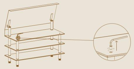
PLACE THE LONG BRACKET ON TOP AND SCREW BACK THE ROUND CAP SCREW.
